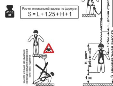
Рис. 9. Способы крепления к анкерным устройствам
